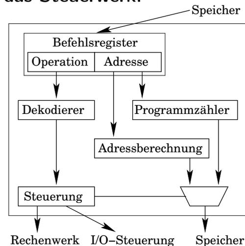
Steuerung: als endlicher Automat oder als Mikroprogramm realisiert
